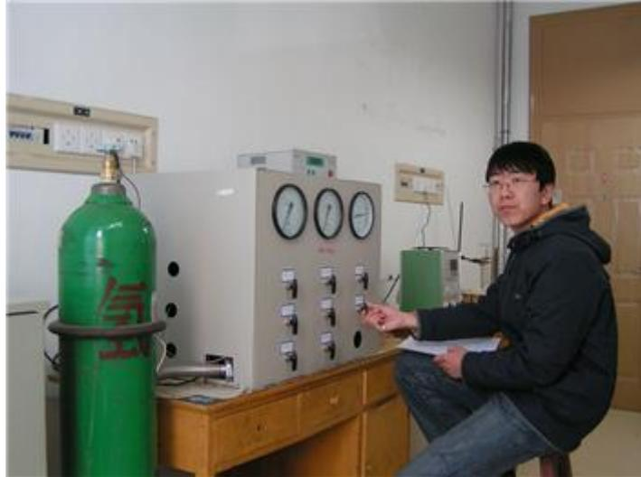
PCT 曲线和压力时间曲线是裴沛所在的课题组测试的常规的表现合金储氢性能的两种代表性曲线。PCT 曲线是表现合金储氢热力学性能的曲线。一条 PCT 曲线通常由很多个点组成，每个点都是通过在相应压力下测量一条压力随时间变化曲线所得到。而为了使测量点能够尽量接近平衡值，一条压力随时间变化曲线通常要耗时两个多小时。以一条由38个点组成的 PCT 曲线为例，测量这条 PCT 曲线所需要的时间就为72小时。像这样的热力学曲线他们一共测了120条。每条曲线含点在24-48个之间，每个点平均耗时2个小时。那么仅仅是热力学曲线就需要测量时间为8640个小时。除此以外，各试样的制备、组织结构检验、动力学性能和活化性能都还需要大量的工作。
